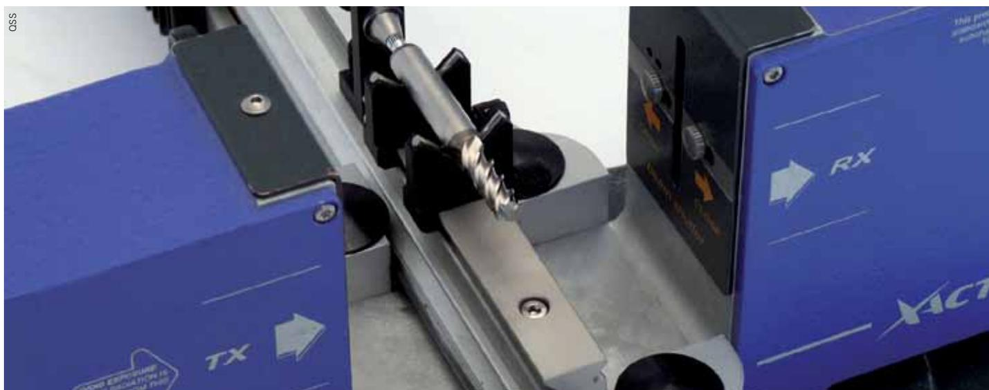
Vollautomatisches Messgerät mit motorisierter Verfahrachse sowie Antrieb zum Rotieren des Werkstücks.
