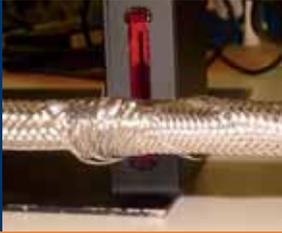
Es sollen Durchmesserabweichungen von Schirmgeflechten erkannt werden. Dazu wird ein Laser-Zeilensensor vom Typ L-LAS-TB-28-T-CL (Sender) und L-LAS-TB-28-R-CL (Empfänger) verwendet. Der Sender-/Empfängerabstand beträgt ca. 100 mm, der Messbereich ca. 28 mm.
